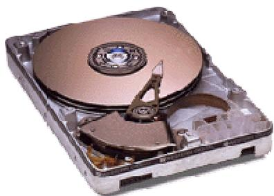
Жесткий диск со снятой крышкой
